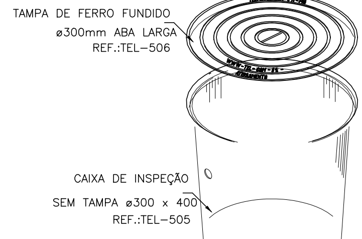
DETALHE - CAIXA DE INSPEÇÃO TIPO SOLO SEM ESCALA
